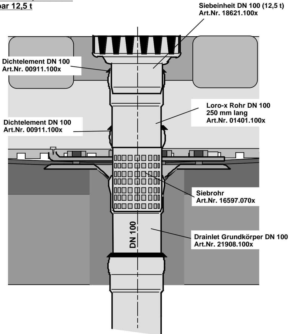
Die Siebaufnahme ist in eine Lastverteilungsschicht einzu-
